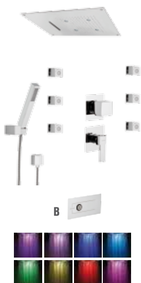
170/L3 Kit wellness composto da: - soffione a soffitto SQ0/L6 in Acciaio Inox 55x40 cm a 2 getti (pioggia e cascata) e 4 faretti LED a 8 colori; - 6 soffioncini quadrati a muro in ottone orientabili ed ispezionabili; - doccetta quadrata in ABS con supporto orientabile in ottone, flessibile 1,5 m e presa acqua quadrata; - incasso doccia art. 179/PA; - deviatore a 5 vie art. 121/PA; Pulsantiera "B" a parete per accensione e controllo colori inclusa. Kit Wellness composed by: - ceiling stainless steel shower head SQ0/L6 55x40 cm 2 jets (rain and waterfall) and 4 LED lights 8 colors; - 6 lateral side jets orientable and inspectable; - square ABS shower chrome and orientable brass holder, flexible 1,5 m and square connecting pipe; - concealed shower mixer 179/PA; - 5 ways diverter art. 121/PA. Wall push-button "B" for on-off and light and colors control included.
