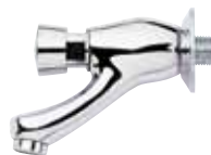
35E/TP Rubinetto frontale temporizzato, 1/2", in ottone cromato, tempo d'apertura 6-8 secondi. Temporized (timer) frontal mounted 1/2" tap, all in c.p. brass, opening time 6-8 seconds.
