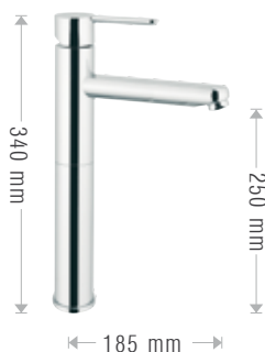
398/NO Miscelatore monocomando lavabo alto XL, senza scarico. Single lever basin mixer high neck XL version, without pop-up waste.
